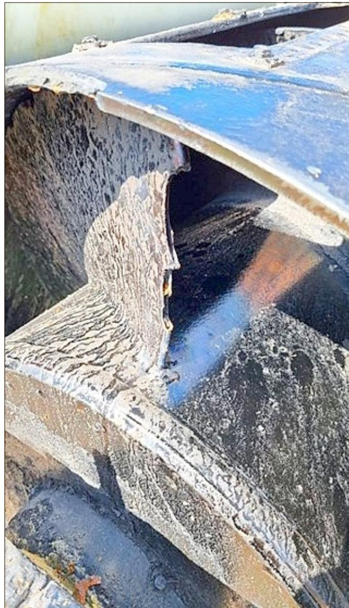
*Korrodierte Schaufelblätter der alten Schneckenpumpen*
